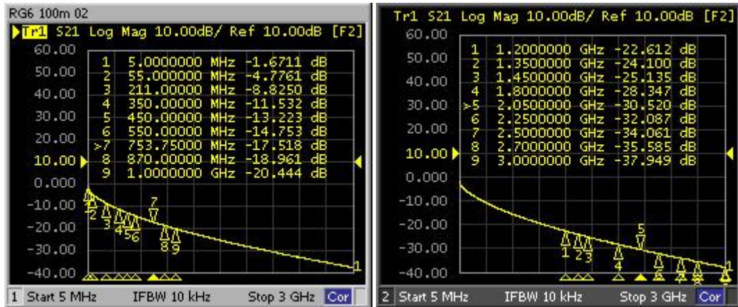
Charakterystyka kabla Tri-Shield DIPOLNET RG-6 Cu. Tłumienie kabla w przedziale częstotliwości 5-3000 MHz.
